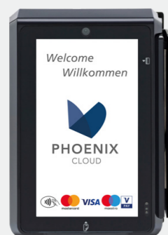
Abbildung 1 Kartenterminal mit Steck-, Magnetstreifen und NFC-Vorhaltescanner
