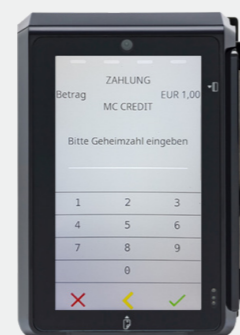
Abbildung 2 Kartenterminal mit PIN-Eingabemöglichkeit auf dem Touchscreen
