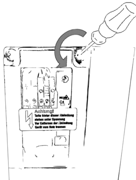
Abb. 5-9 Deckel der Anschluss-Isobox Spannungsversorgung lösen
