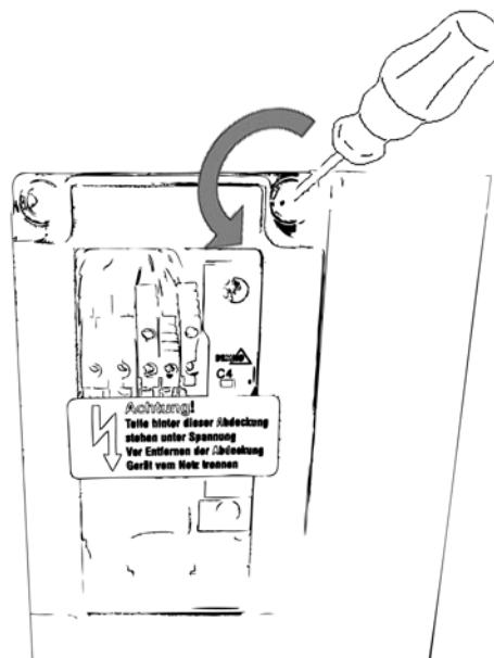
Abb. 6-16 Deckel der Anschluss-Isobox Spannungsversorgung lösen
