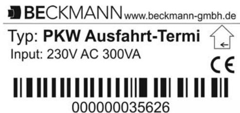
Abb. 1-2 Typenschild Ausfahrtsäule PKW-Parkplatz
