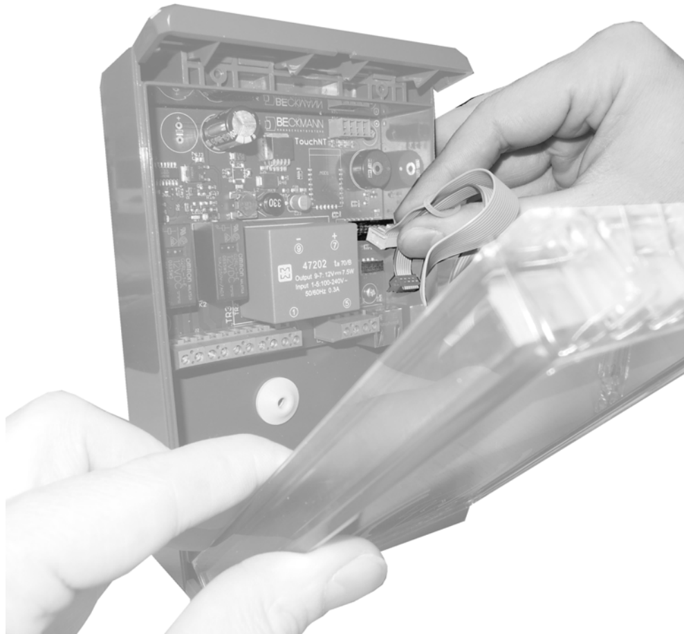
Abb. 5-4 Stecker abstecken und Bedienfront abnehmen
