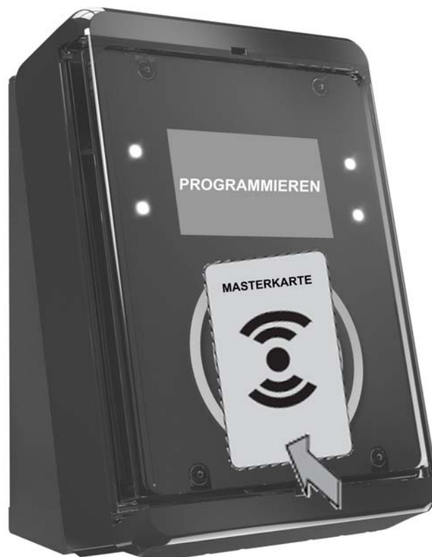
Abb. 7-1 Programmiermodus mit RFID-Masterkarte aktivieren
