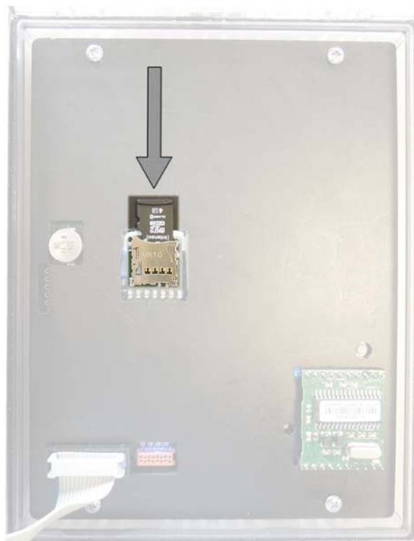
Abb. 9-1 Softwareupdate MicroSD-Karte stecken
