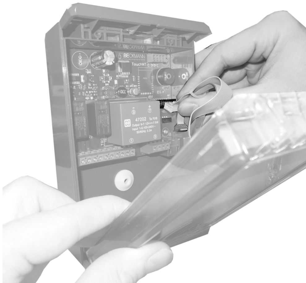
Abb. 5-14 Bedienfront aufnehmen und Stecker verbinden
