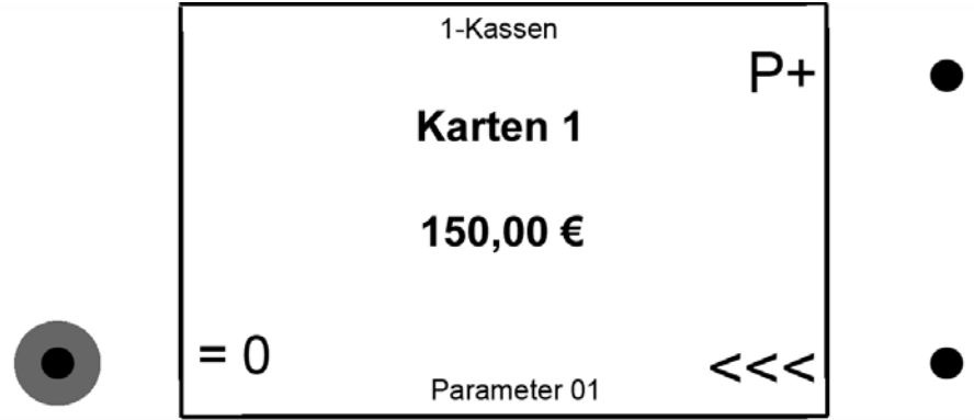
Abb. 7-8 Untermenü - Parametereditierung am Bsp. Rücksetzung Kassenzähler
