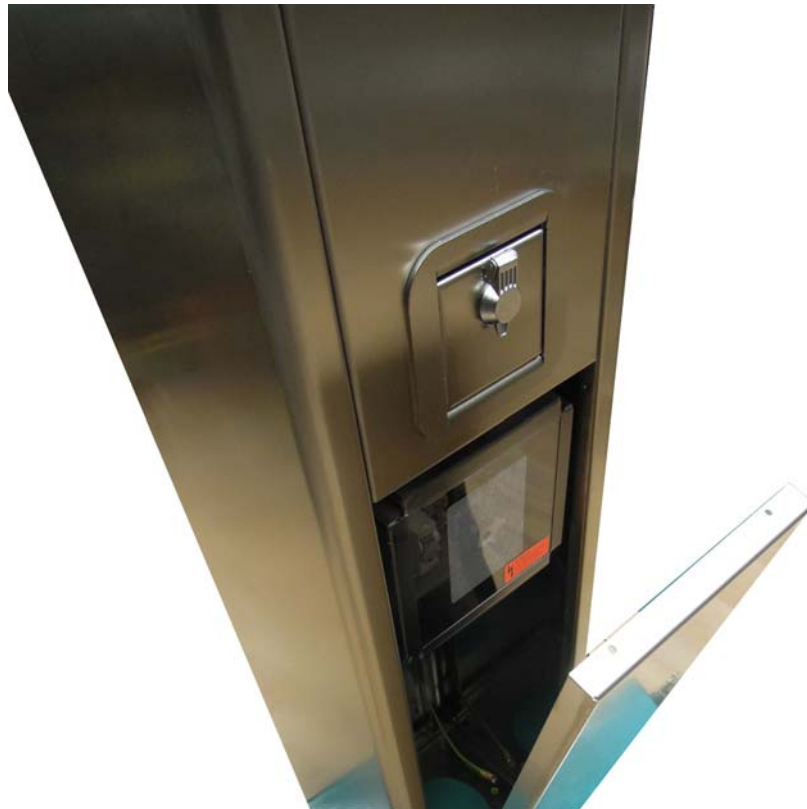
Abb. 3-1 Warnschild auf dem Deckel der Anschluss-Isobox bei geöffneter Klappe hinten
